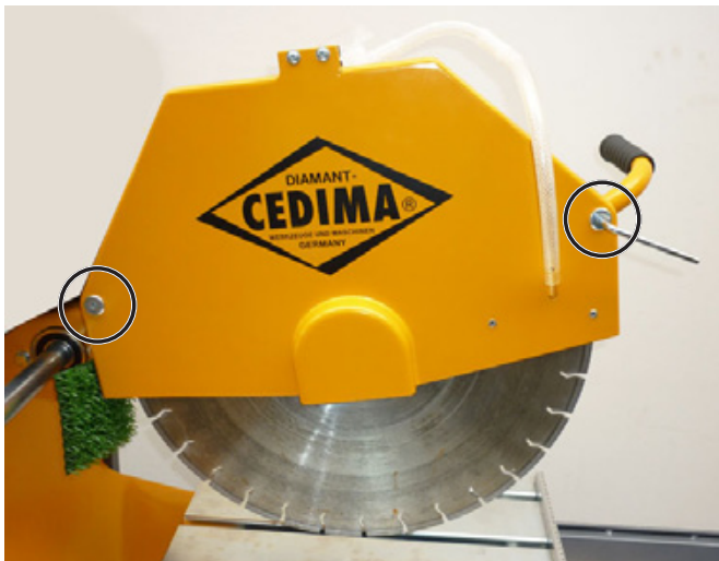
Trennscheibenschutz schließen und mit den Rundmuttern sichern
