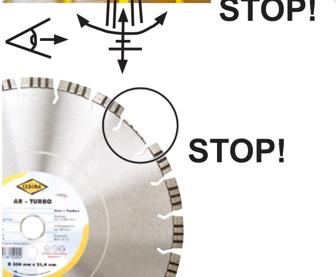
Defekte, flatternde, unrund laufende Diamant-Trennscheibe mit fehlenden Segmenten wechseln
