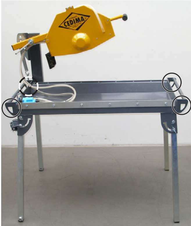
Kran-Ösen an den Griffrohren der CTS•56, Rolltisch und Trennscheibe demontiert
