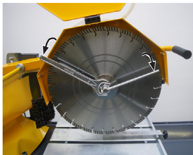
Druckflansch mit der Schneidwellen-Mutter an die Diamant-Trennscheibe spannen Bild 4.30
