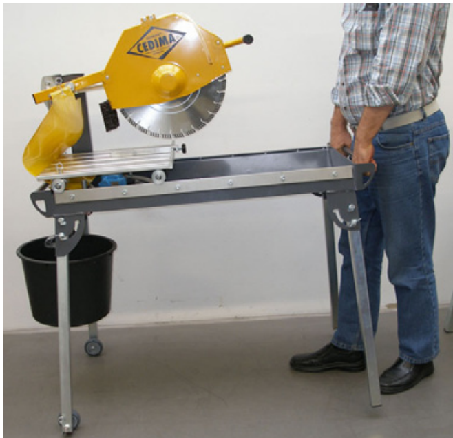
Transport der Tischsäge mit an den Standfüßen montierten Rollen
