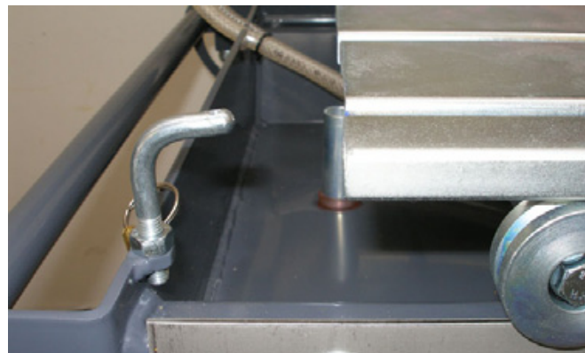
Rolltisch-Transportsicherung montiert Bild 5.7
