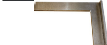
90°-Winkel (Horizontal), Rolltisch zu Trennscheibe prüfen Bild 5.4
