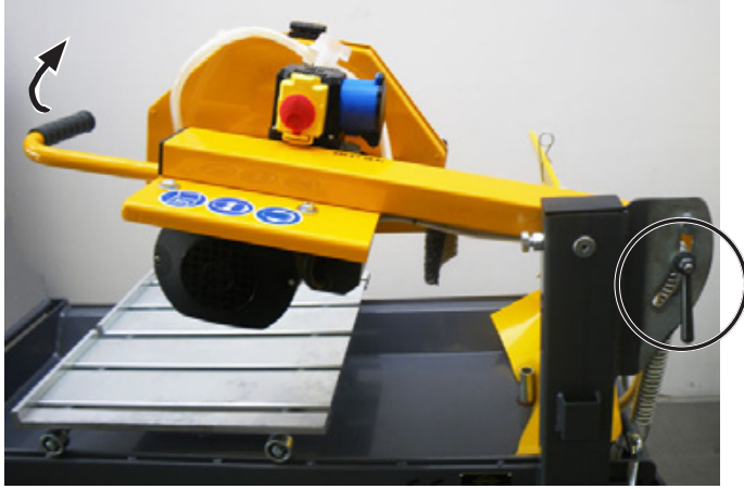
Pendelschneidarm ausheben und mit Klemmhebel arretieren Bild 4.23
