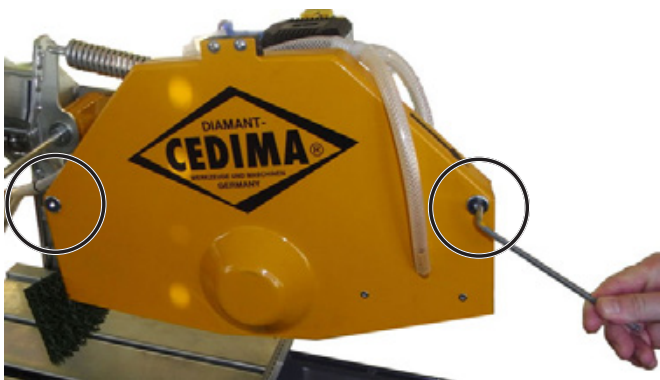
Rundmuttern am Trennscheibenschutz lösen
