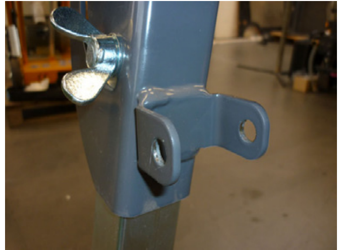
Rollen-Halter am Tischsägenrahmen
