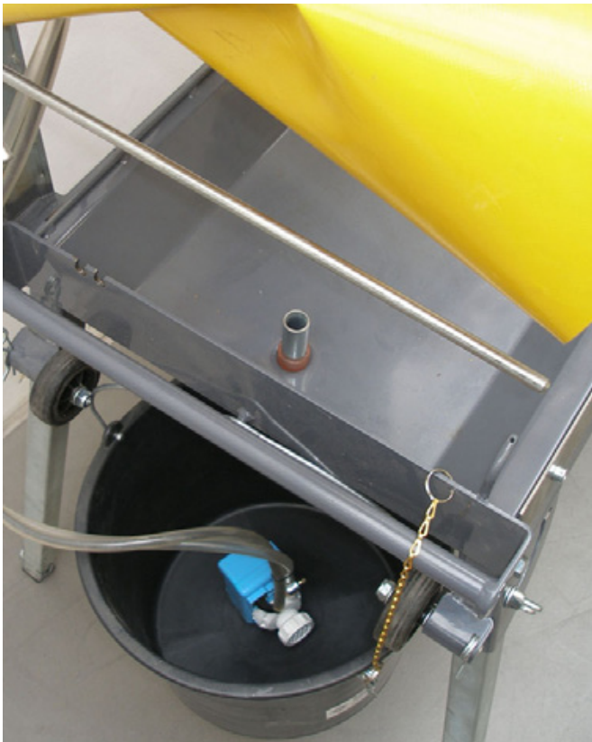
Überlaufstopfen im Abfluss der Wasserwanne, Wasserpumpe im Baueimer am Tischsägen-Rahmen
