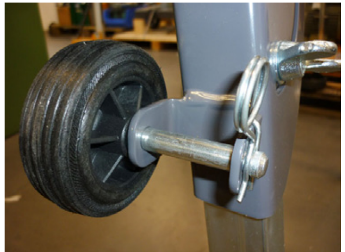
Rolle am Tischsägen-Rahmen montiert
