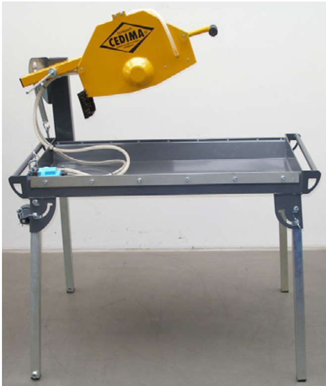
Zweites Standfuß-Paar abgeschwenkt (Tischsäge aufgestellt) Bild 4.11
