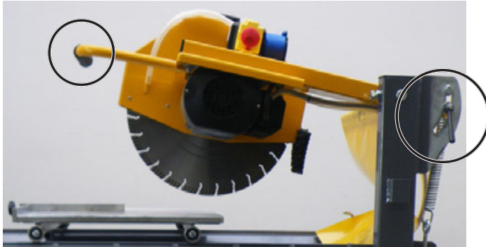
Klemmhebel lösen und den Pendelschneidarm festhalten Bild 4.34
