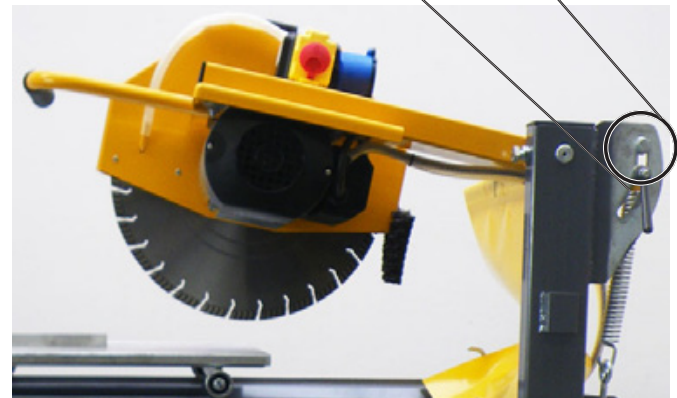
Pendelschneidarm Tiefen-Anschlag montiert Bild 4.36
