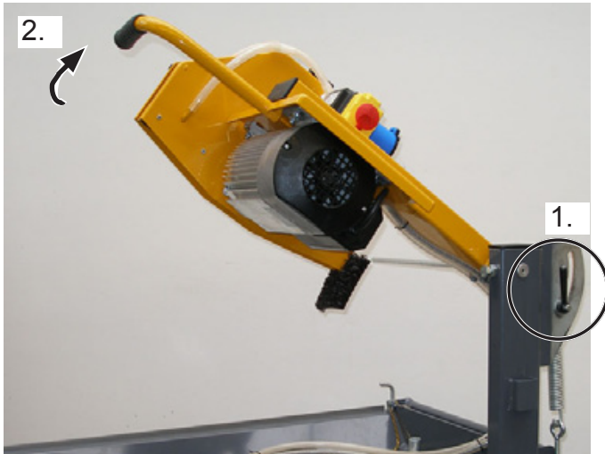
Klemmhebel lösen und Pendelschneidarm maximal ausheben Bild 4.13
